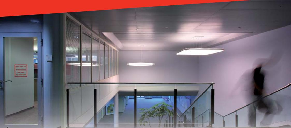
L'éclairage artificiel doit permettre d'assurer des valeurs d'éclairement par exemple d'au moins 20 lux en tout point du cheminement extérieur accessible, 100 lux en tout point des circulations intérieures horizontales, 150 lux en tout point de chaque escalier.
